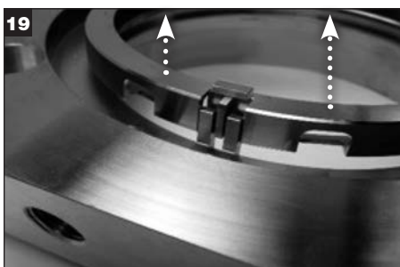
19 Vyjměte kanál pohonu z příruby; vyjměte kanálové svorky a deflektor průtoku z kanálu a zlikvidujte je.
