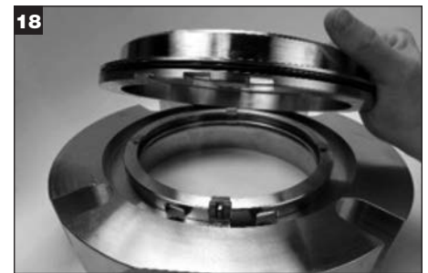
18 Z příruby vyjměte adaptér. Vyjměte O-kroužek adaptéru (Z) a zlikvidujte jej. Adaptér dejte stranou.
