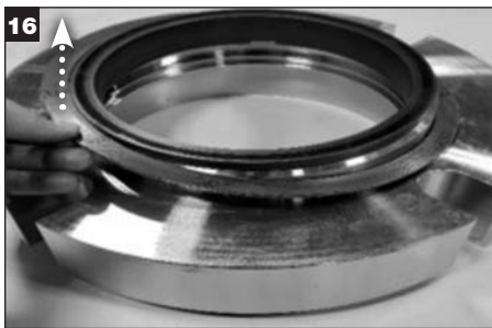
16 Vyjměte těsnění z adaptéru a zlikvidujte je.
